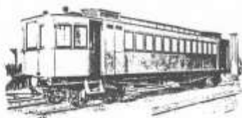
Accu-motorrijtuig van de Belgische Staatsspoorwegen (Foto SCHERREL, Verzameling Prof. Dr. Ir. A. D. de Pater, België)
